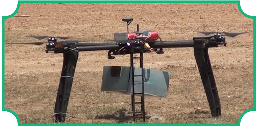
බහුවර්ණාවලි චෝන කැමරාව (කොළ 550nm, රතු 660nm, රතු දාරය 735nm, අධෝරක්ත ආසන්න 790nm)
