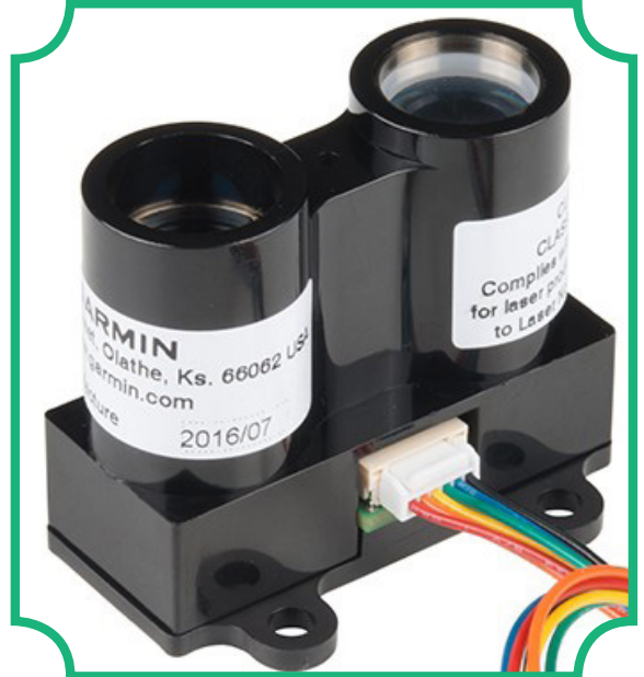
LiDaR Lite v3 සංවේදකය (905nm laser)
