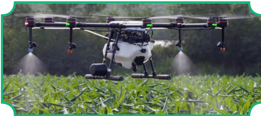
බෝග වෙත ඉහීමක යෙදෙන DJI අග්‍රාස් MG1S චෝනය
